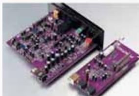
Esprit不僅採用高檔的Wolfson WM8716數位類比轉換晶片，類比轉數位的Cirrus Logic CS5361晶片同樣高級，兩者皆支援最高24bit/192kHz高解析音樂檔，所以無論DAC或ADC都擁有出色表現，至於耳機擴大機部份，Esprit所使用的TI TPA6120A2放大晶片也非常優異，舉凡16至600歐姆的耳機都能驅動自如，完整發揮耳機的潛能。光從晶片看來，我們就能發現ADL的確在Esprit下了不少苦心，所以表現出色是在自然不過的結果。
